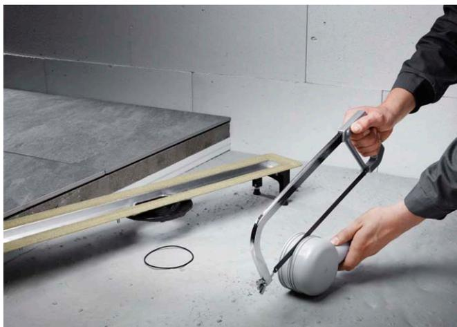
Un montage particulièrement aisé : le modèle d'écoulement standard peut être tourné à 180° et facilement scié puis enfiché au besoin sur place pour être transformé en modèle pour la rénovation.
