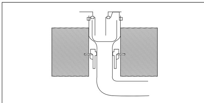
Le modèle d'écoulement vertical peut être installé avec le fourreau pour protection incendie modèle 4923.5, par exemple pour être monté dans des bâtiments publics.
