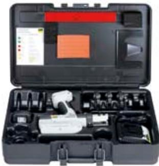
Fournie avec la Pressgun Picco : la mallette de mâchoires à sertir, au choix pour les systèmes métalliques (15, 22, 28 mm) ou PE-Xc (16, 20, 25 mm).
