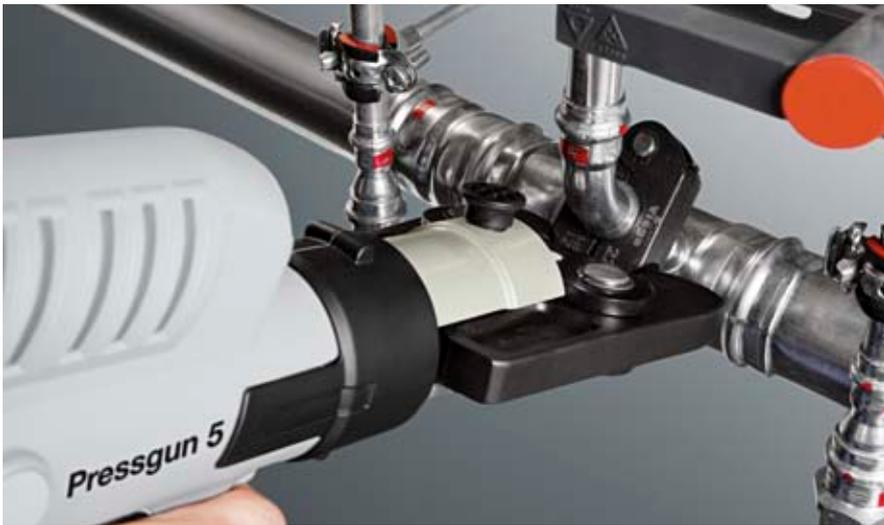
La tête de sertissage orientable à 180° et les anneaux de sertissage à fonction articulée garantissent une flexibilité maximale dans toutes les situations de travail.
