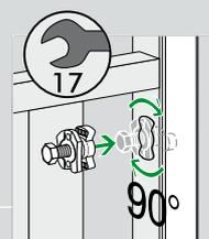
Poser les rails verticaux avec les modules à une distance de 430 mm. En cas de rails sans modules, la distance ne doit pas dépasser 500 mm. Insérer ensuite les coulisseaux dans le profilé et les pivoter à 90°. Serrer ensuite à l'aide d'une clé polygone de 17.
