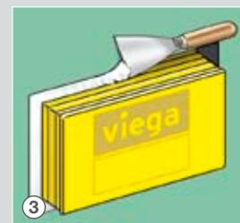
3 Remplissage des arêtes de coupe avec du mastic.
