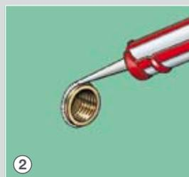
2 Etanchéité des orifices d'alimentation en eau.
