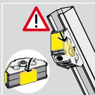
En cas d'utilisation du côté long du raccord, un élément de blocage est requis pour le côté court.
