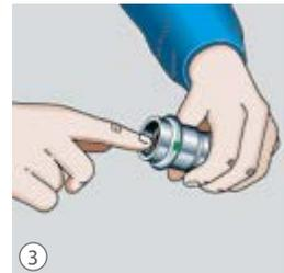
Abb. 56 Korrekten Sitz des Dichtelementes prüfen.
