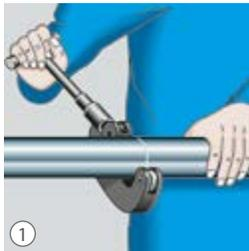
Abb. 61 Rohr fachgerecht abgelängen.
