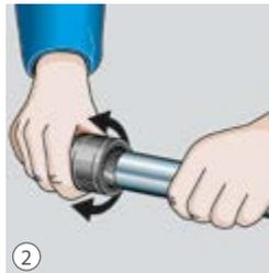
Abb. 55 Rohr innen und außen entgraten.
