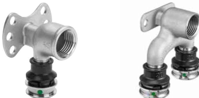
Für optimale Strömungseigenschaften werden Raxinox-Verbinder im Feingussverfahren (Gewindebauteile) und Umformverfahren (T-Stücke, Bögen) hergestellt.
